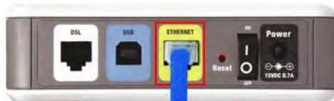
Vista de la parte trasera del módem DSL
